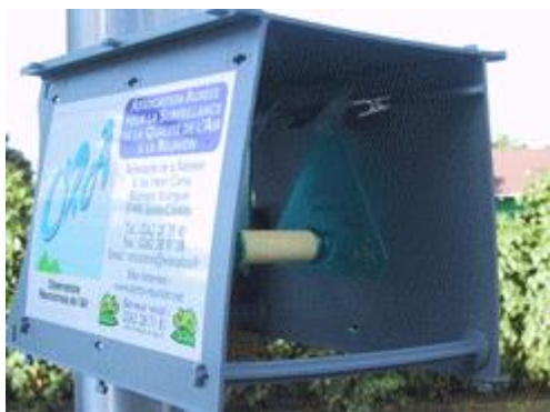
FIGURE 19 : TUBES PASSIFS (RADIELLO) DANS LEUR ABRI – SOURCE : SITE INTERNET D'ATMO REUNION
