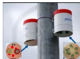
Capteur passif PASSAM pour mesure du NO 2
