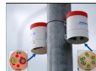
FIGURE 79 – CAPTEURS PASSIFS PASSAM (GAUCHE) ET COMPTEURS OPTIQUES DE PARTICULES PM10 ET PM 2,5 (DROITE)
