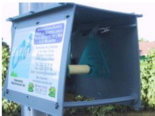
FIGURE 19 : TUBES PASSIFS (RADIELLO) DANS LEUR ABRI – SOURCE : SITE INTERNET D'ATMO RÉUNION
